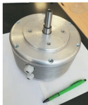
Экспериментальный образец двухстаторного электродвигателя мощностью 3 кВт с применением компонентов из композиционного магнитомягкого материала
