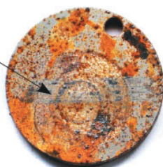
Коррозионные повреждения металлического контртела после ускоренных климатических испытаний
