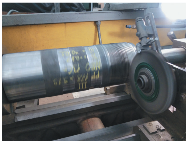
Процесс нанесения алюмоцинкового покрытия на соединительную резьбовую поверхность трубы
