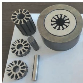
Пример матрицы для изготовления статора электромотора беспилотных летательных аппаратов методом прессования
