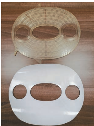
Мембрана ПС-100М в виде пластин для мембранного модуля M37 (Alfa Laval)
