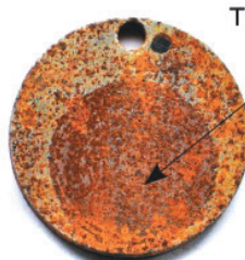
Коррозионные повреждения металлического контртела после ускоренных климатических испытаний
