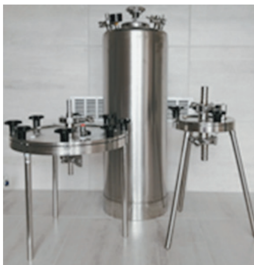
Установка стерилизующей фильтрации, укомплектованная мембранами ПА-0,45
