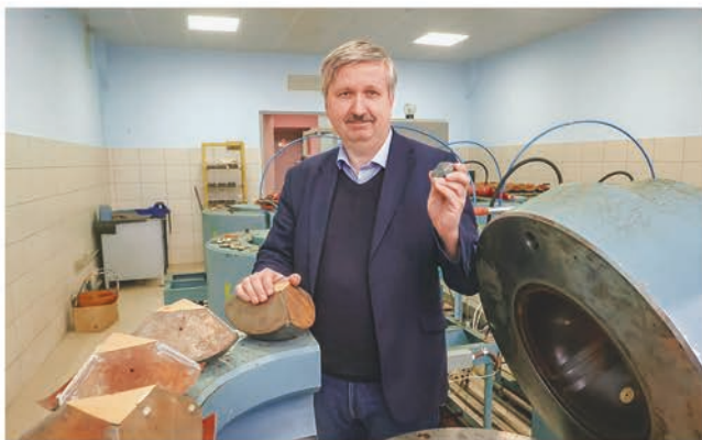
Установка высокого давления для синтеза монокристаллов алмазов
